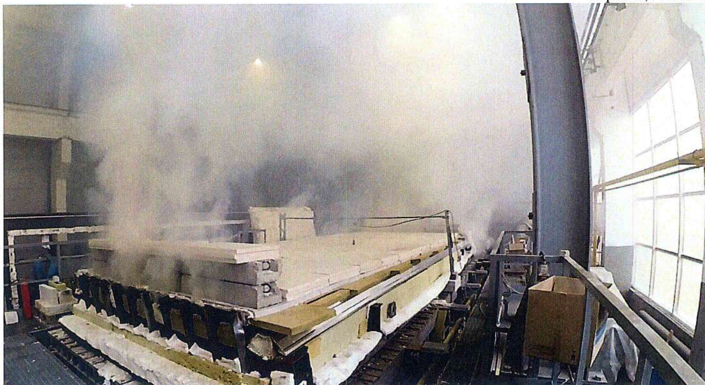
Фото 3 – Интенсификация дымовыделения (9 минута от начала огневого воздействия)
